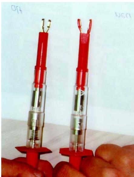
**Bild:** Teilisolierte Abgreifklemmen können Störlichtbögen vermeiden.
